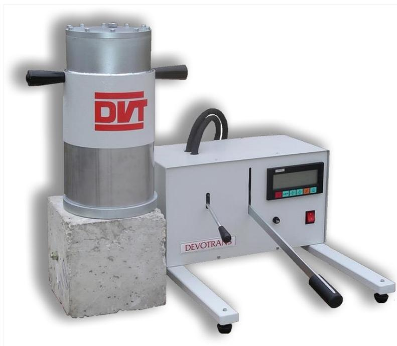
PERMET D'EFFECTUER DES ESSAIS DE DETACHEMENT ET
